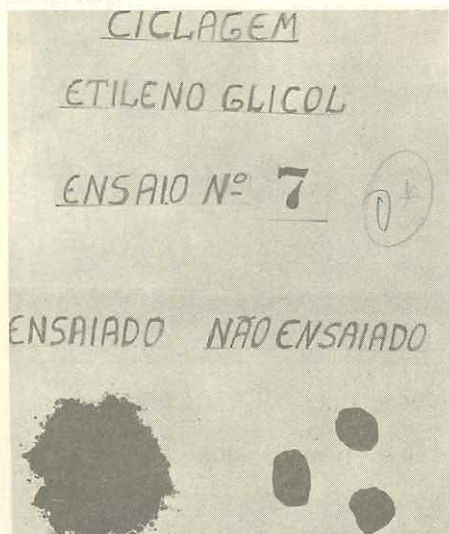
Figura 5.9 - Basalto submetido ao ensaio de imersão em etileno glicol. Obra de Porto Primavera
