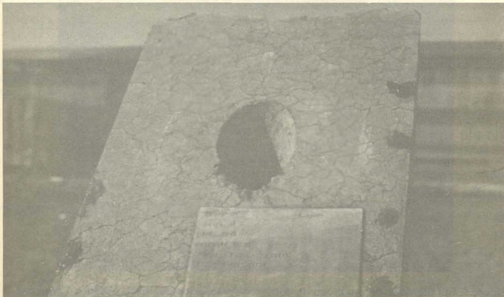
Figura 5.13 - Situação de um bloco de concreto com 6 anos de idade, moldado com agregado pyrex e cimento com álcalis de 0,97% (Laboratório de Ilha Solteira), sem pozzolana
