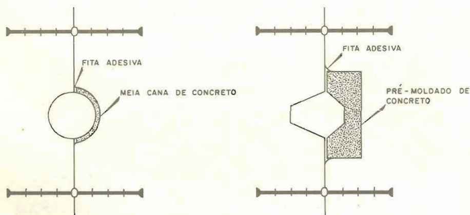
Figura 10.26 - Drenos em juntas de contração
