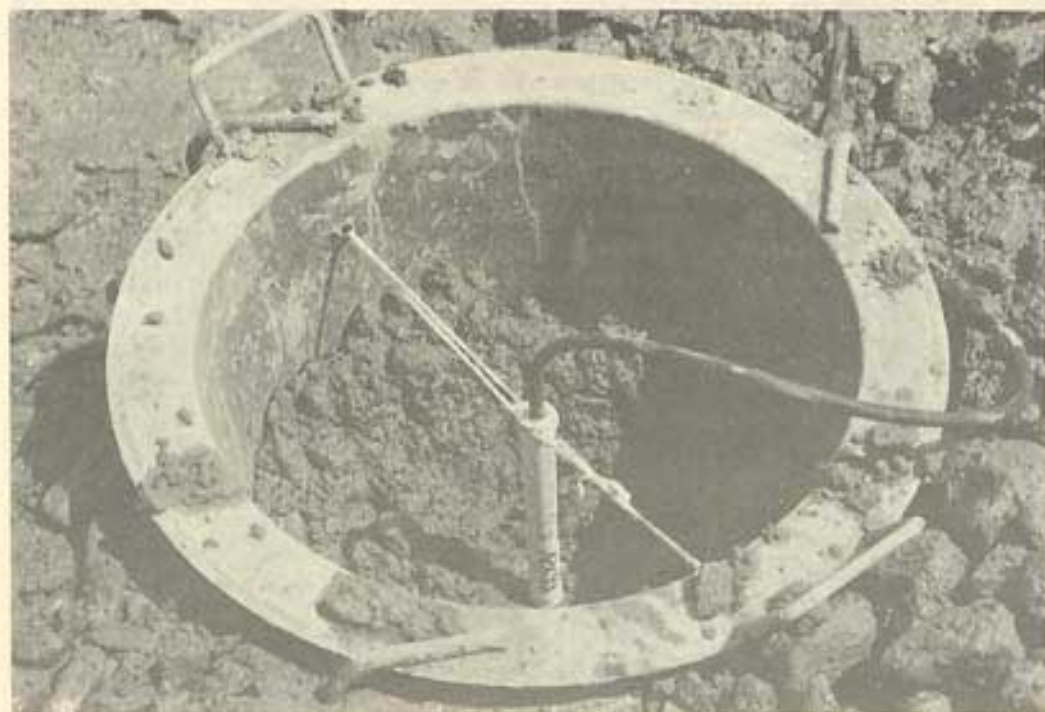
Figura 14.6 - Extensômetro corretor, para medida da variação autôgena - Itaipu
