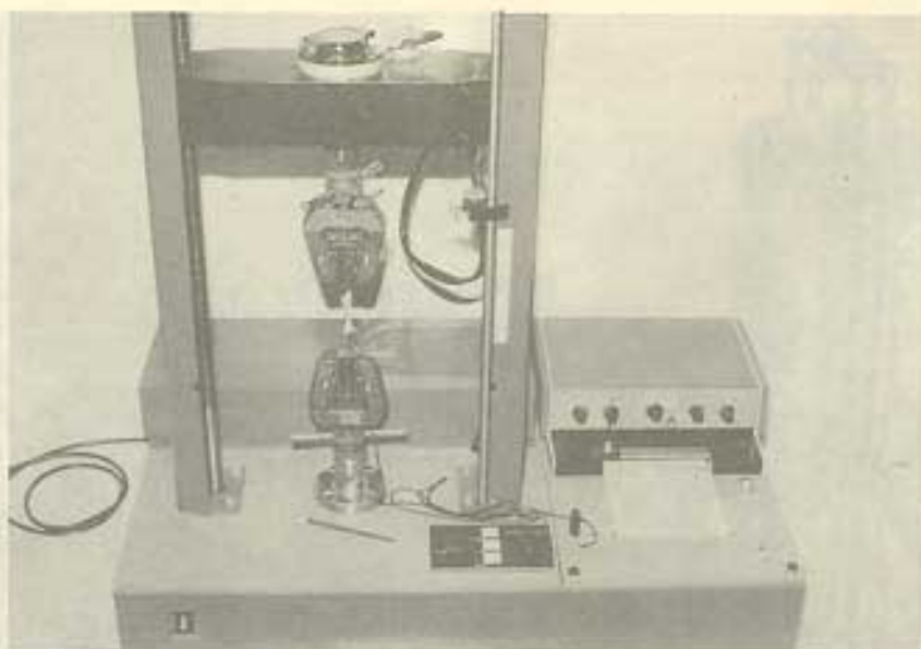
Figura 4.34 - Prensa elétrica para Tração e Alongamento de Elastômetro; Capacidade 2.000 kgf - Itaipu
