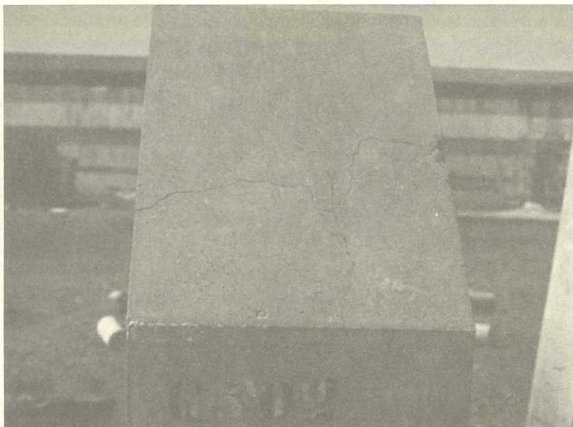
Figura 5.14 - Situação de um bloco de concreto com 6 anos de idade, moldado com cascalhos de ágata, calcedônia, quartzo e cimento com álcalis de 1,05% (Laboratório de Ilha Solteira), sem pozolana
