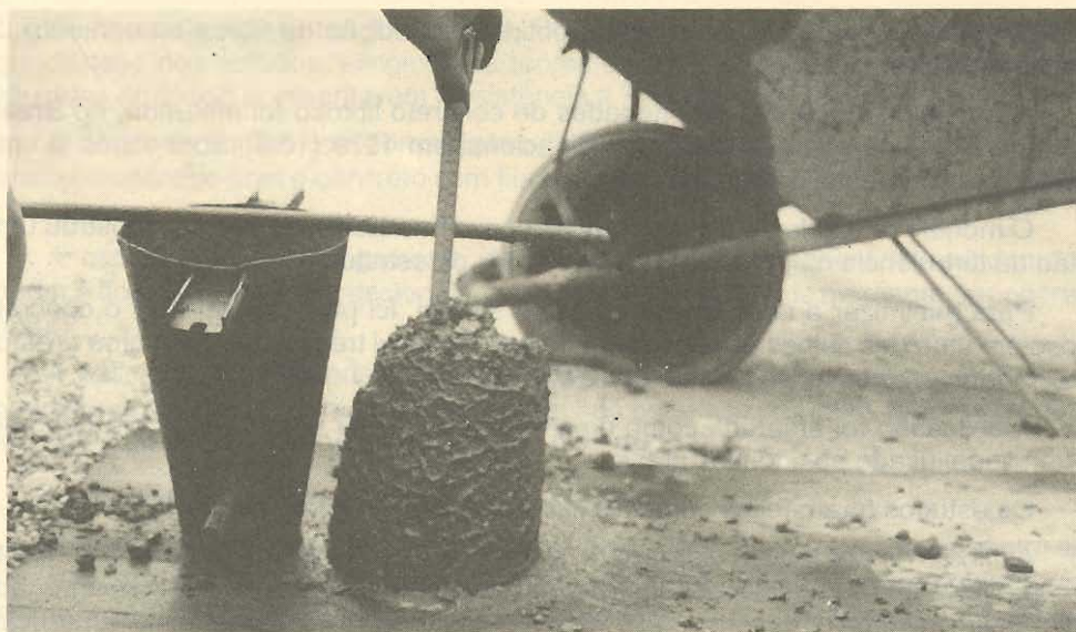
Figura 16.10 - Concreto bombeável, bem argamassado - Pehuenche - Chile
