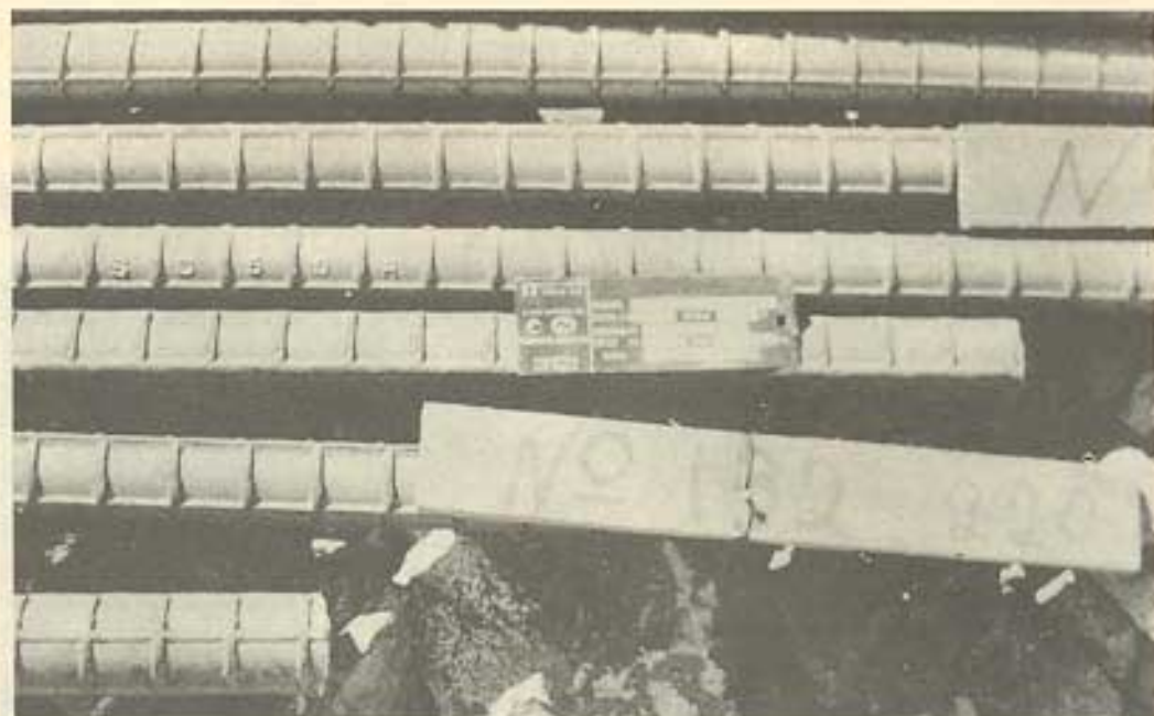
Figura 8.47 - Feixes de barras, estocados, aguardando liberação de qualidade, através de ensaios em laboratórios - Itaipu
