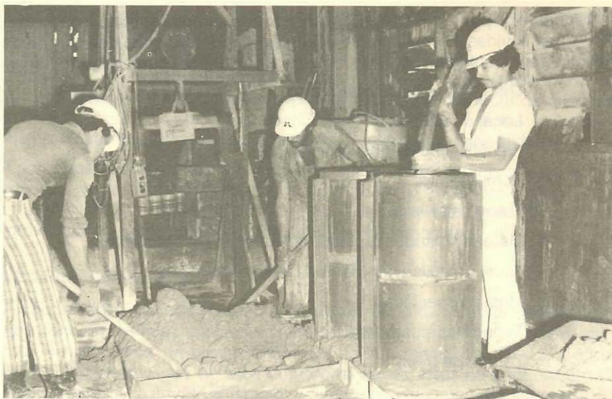
Figura 9.24 - Moldagem de corpo de prova D 45 x 90 cm com concreto integral de agregado D Máx. 152 mm
