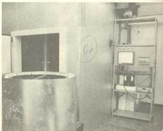
Figura 4.30 - Câmara para Ensaio de Elevação Adiabática da Temperatura do Concreto - Itaipu
