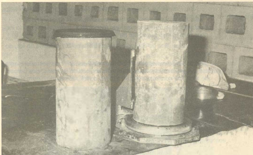
Figura 9.27 - Capeamento de corpos de prova cilíndricos D 15 x 30 cm, de acordo com metodologia adequada - Itaipu
