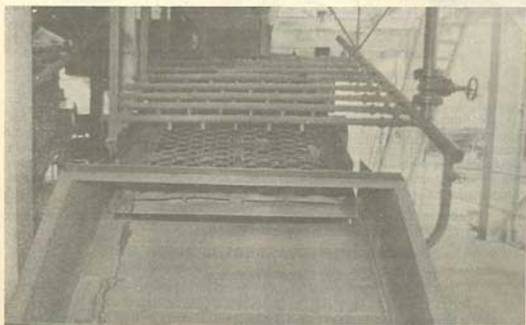
Figura 8.22 - Peneira vibratória para agregado graúdo, com malha redonda - Rosana
