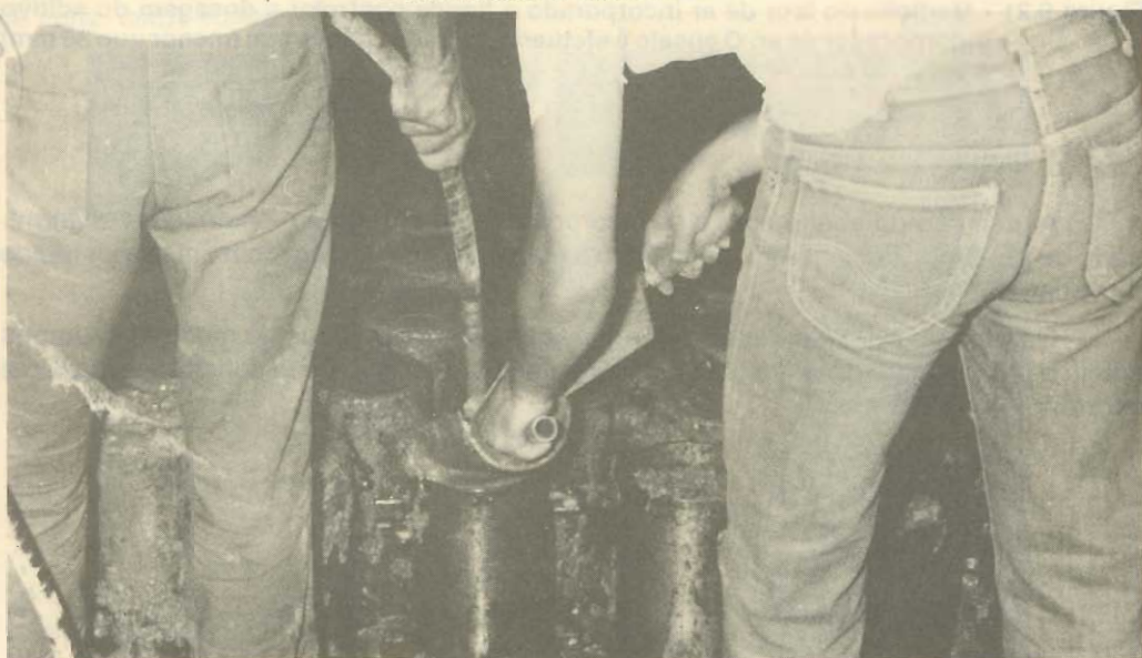
Figura 9.23 - Moldagem de corpos de prova cilíndricos D 15 x 30 cm com a fração inferior a 38mm, a partir do concreto integral - Itaipu
