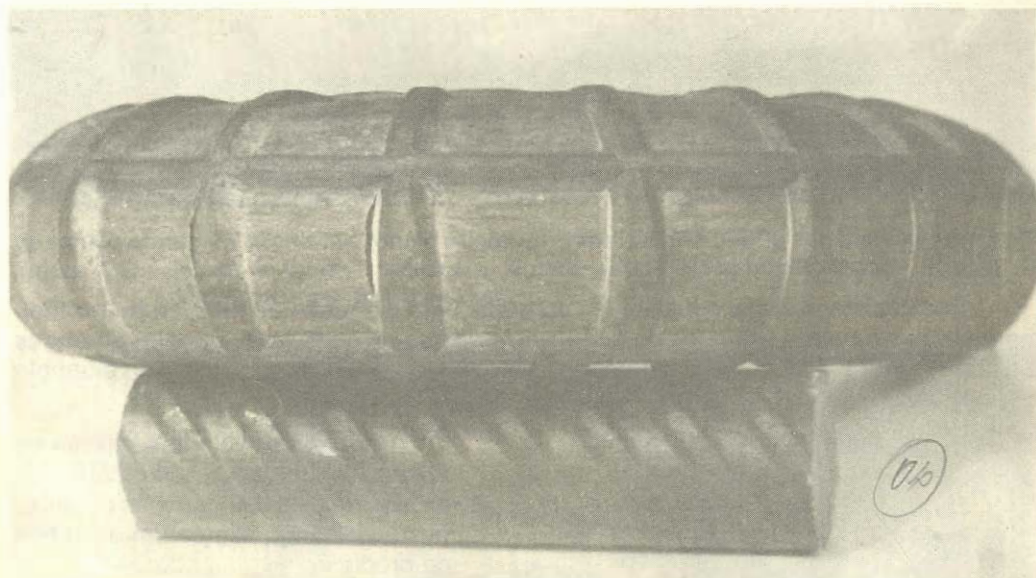
Figura 8.44 - Aço após ensaio de dobramento, apresentando esfoliação
