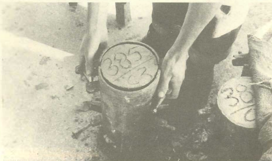
Figura 9.25 - Desforma dos corpos de prova. Nota-se a identificação do grupo de corpos de prova (nº 385) e da central de concreto (c-3) - Itaipu
