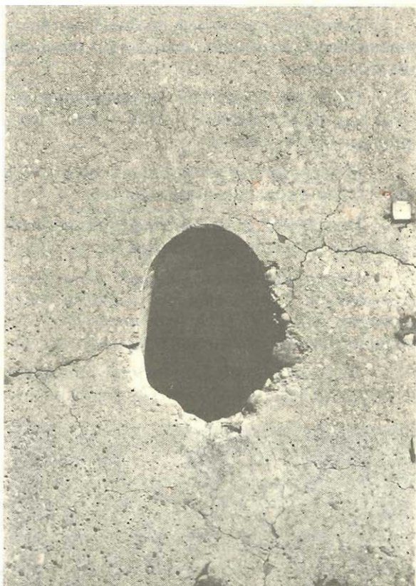
Figura 7.4 - Situação de um bloco de concreto com 20 anos de idade, moldado com agregado de ágata, calcedônia e quartzo, e cimento com 1,05% de álcalis. Comparar com a Figura 5.14 (excetuando o furo do testemunho). Laboratório da CESP - Ilha Solteira
