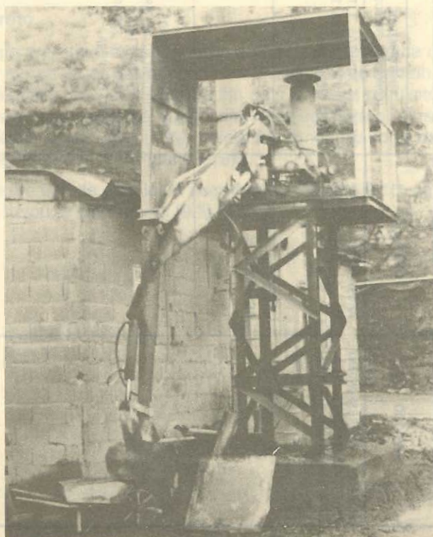
Figura 9.17 - Amostrador hidráulico, para extração de amostras da caçamba do Dumpcrete
