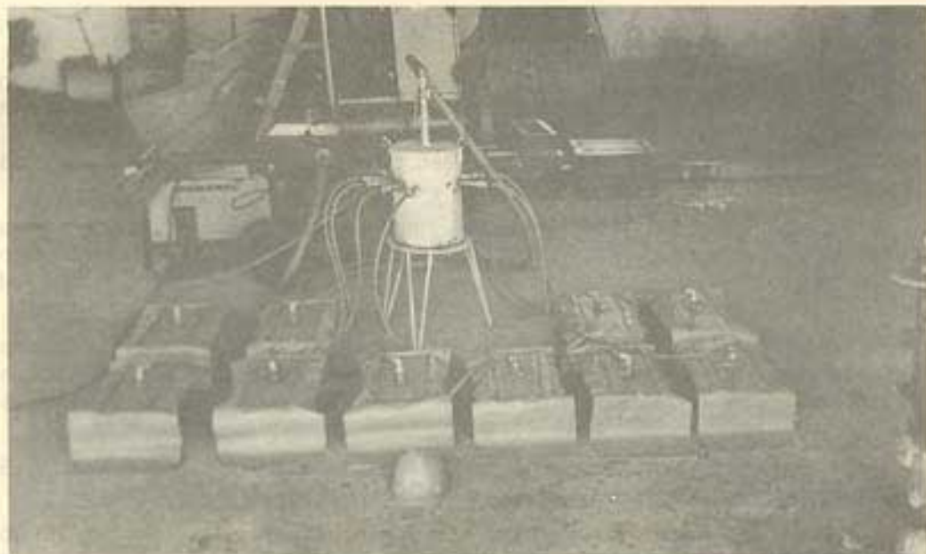
Figura 16.7 - Avaliação do processo, através de moldagem de vigas para ensaios de flexão - Emborcação
