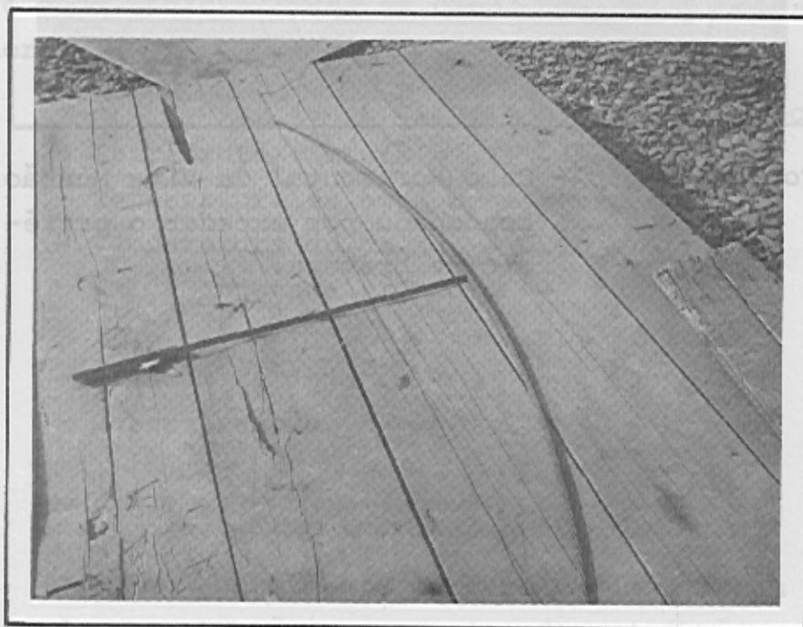
Fotografia 65 - Aço Bravo - Fora da especificação - Flecha de 23 cm para 2 m.
