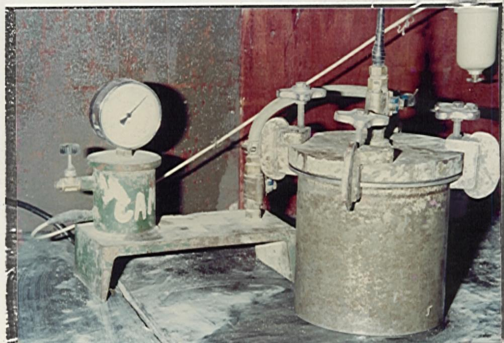
Figura 43 - Avaliação do teor de ar incorporado a fim de controlar a dosagem do aditivo incorporador de ar. Ensaio efetuado na fração  $\leq 38$  mm a partir do concreto integral
