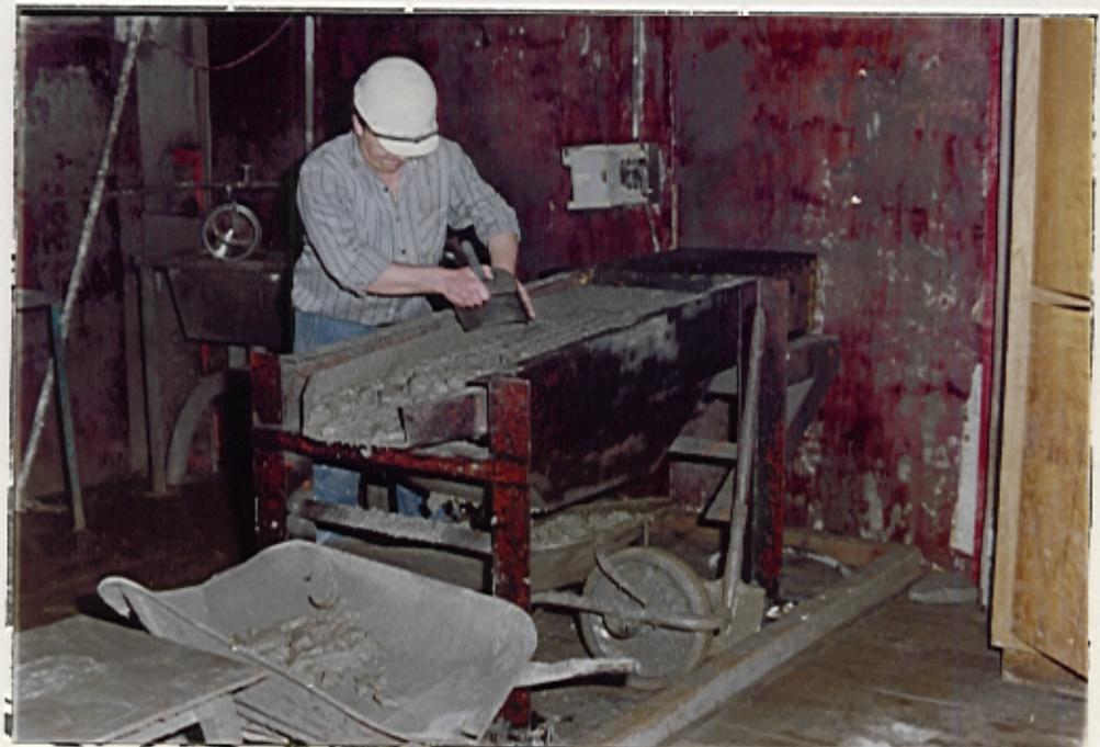
Figura 41 - Separação pelo peneirador de concreto, da fração superior a 38 mm, no concreto massa, para ensaios de controle durante a produção e para as diversas moldagens.
