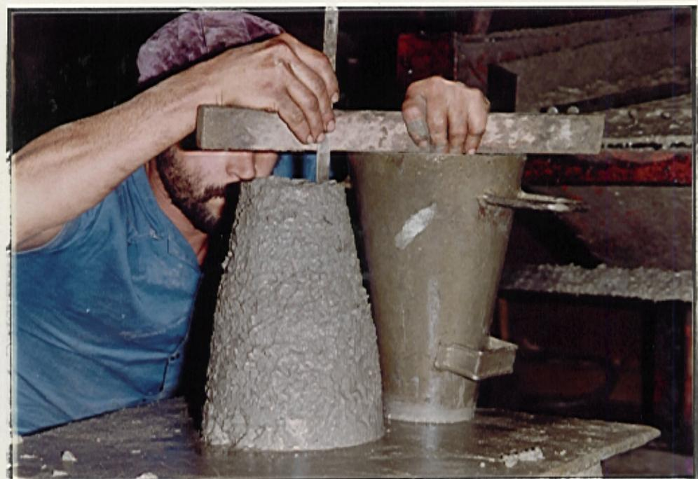
Figura 42 - Avaliação da trabalhabilidade da fração penirada ( $\leq 38$  mm) a partir do concreto massa ( $\phi$  máx. 76 ou 152 mm).
