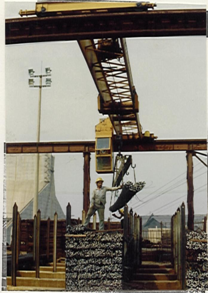
Figura 28: Ponte rolante para descarga, estocagem nas baias, e manuseio dos feixes.
