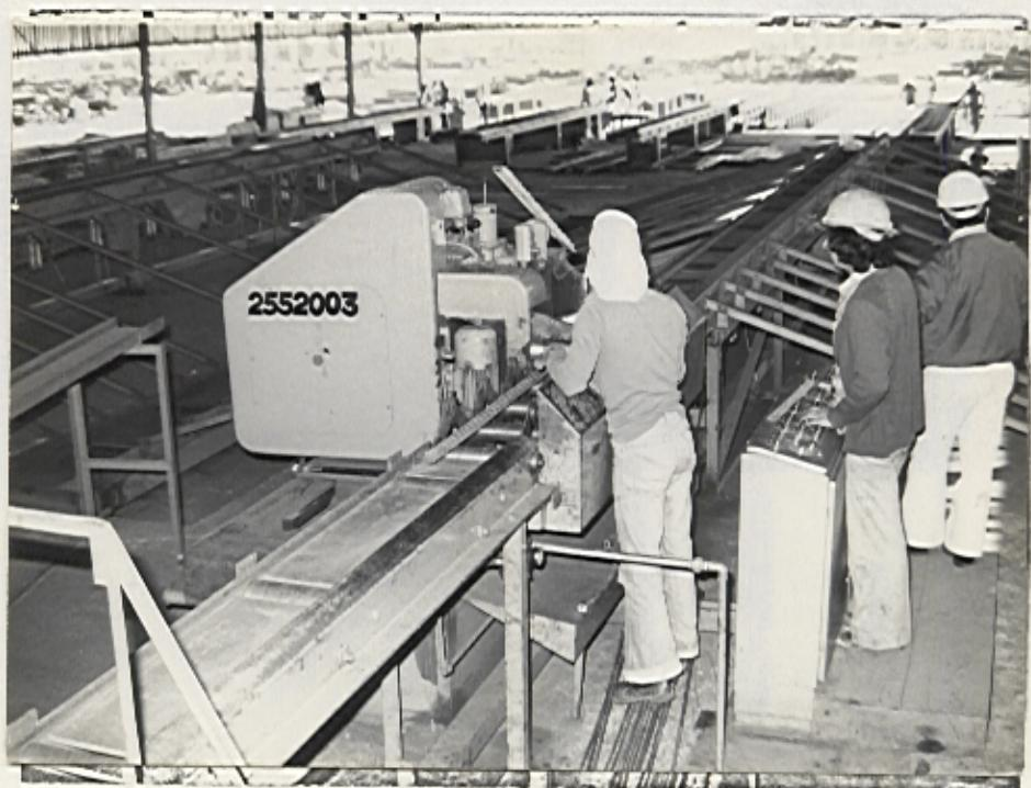
Figura 29: Vista de uma das linhas de corte com guilhotina de regulagem pantográfica.
