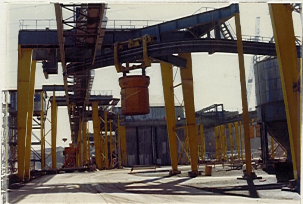
Figura 23: Sistema de rolamento da monovia, vendo-se um moto-carro com caçamba e ao fundo carro de transferência para transbordo às caçambas do cabo aéreo.
