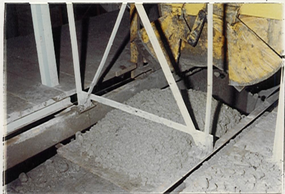
Figura 40 - Coleta de amostras do concreto, na Central de Produção através de "carrinho amostrador" cortando o fluxo de descarga do concreto.
