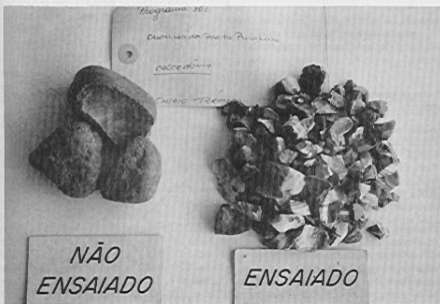
Figura 3 — Aspecto de fragmentação de agregados reativos, após a execução do Ensaio Térmico (Ensaio Ossipov).
