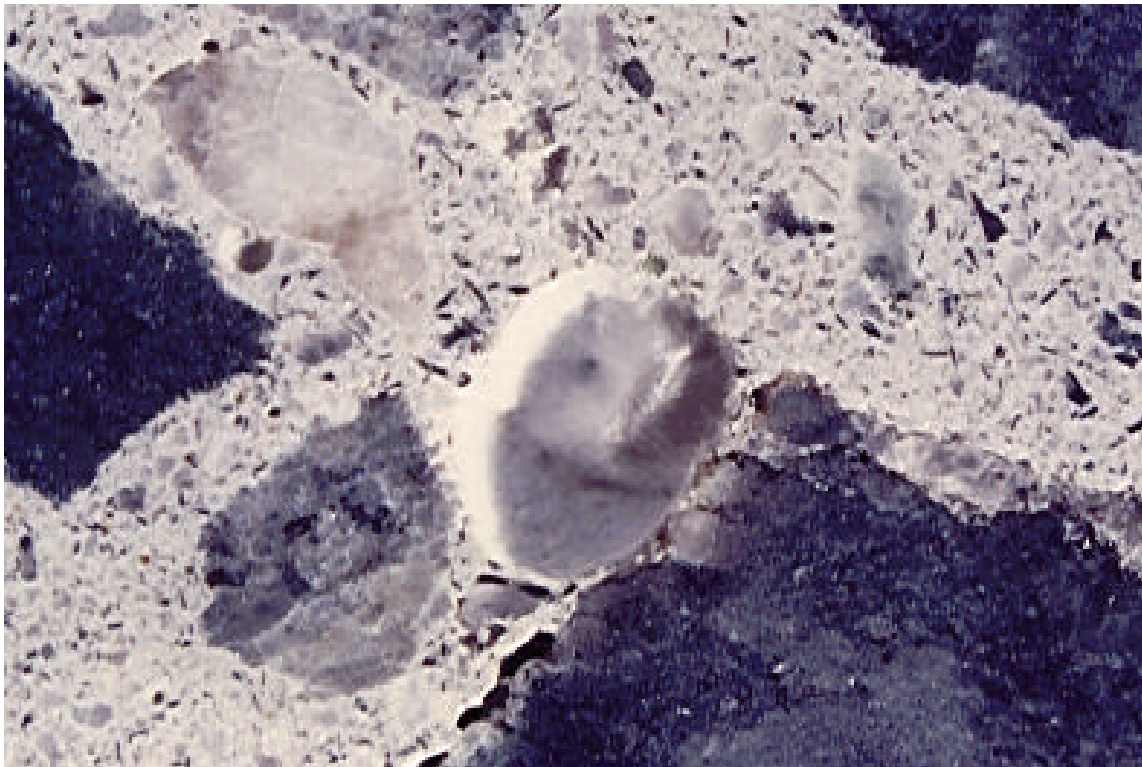
Figura 16- Exsudação de gel da RAA , nas proximidades do agregado- Obra no Brasil.
