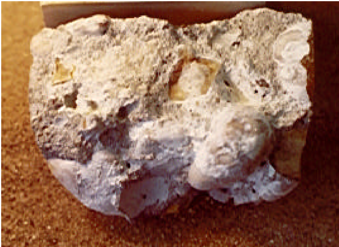
Figura 14- Exsudação de gel da RAA junto à superfície de agregados – Amostra existente na Portland Cement Association –Estados Unidos.
