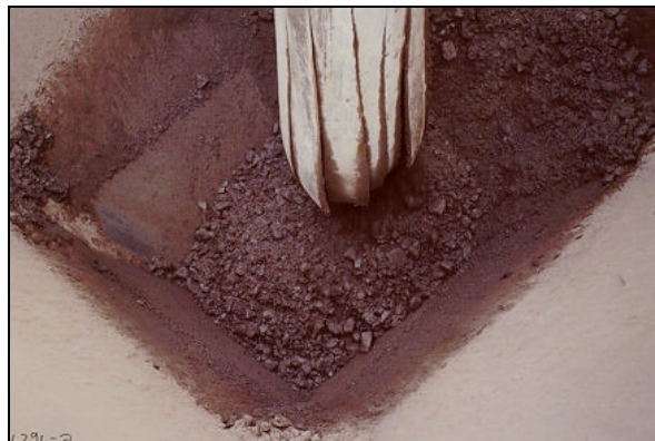
Figura 01- Adaptação no chute de descarga na saída dos misturadores para minimizar a segregação
