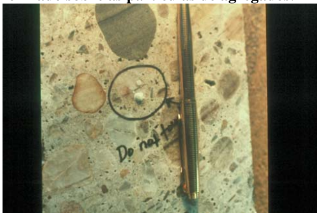
Figura 19- Gel expansivo formado pela ação dos álcalis do cimento com a sílica dos agregados.
