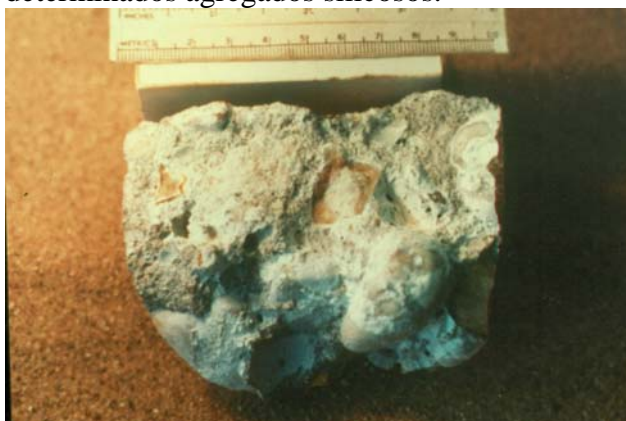
Figura 18- Gel (Elemento de coloração clara) formado sobre as partículas de agregados.
