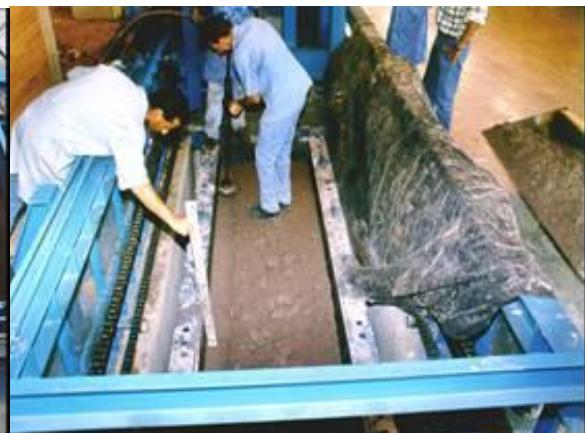
Medição da altura da camada de CCR e compactação junto a lateral do molde
