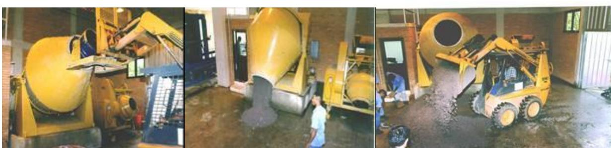
Produção do CCR em Laboratório usando misturador de 1,5m<sup>3</sup> de capacidade
