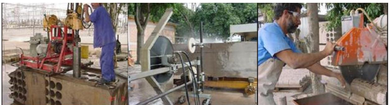
Extração de testemunhos do bloco ensaio de CCR, para obtenção de corpos de prova
