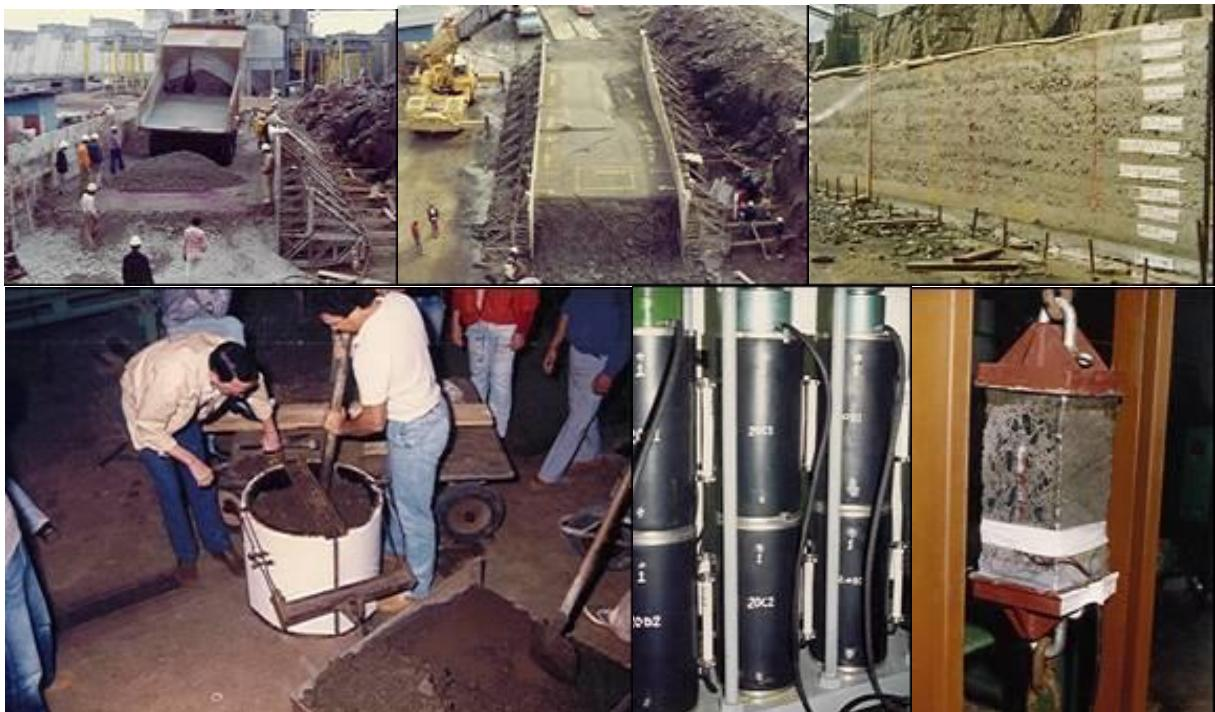
**ITAIPU-** Aterro experimental e ensaios de laboratório (Evolução Adiabática de Temperatura; Fluência e Capacidade de Alongamento) para as barragens de Urugua-i (Argentina) e Capanda (Angola)
