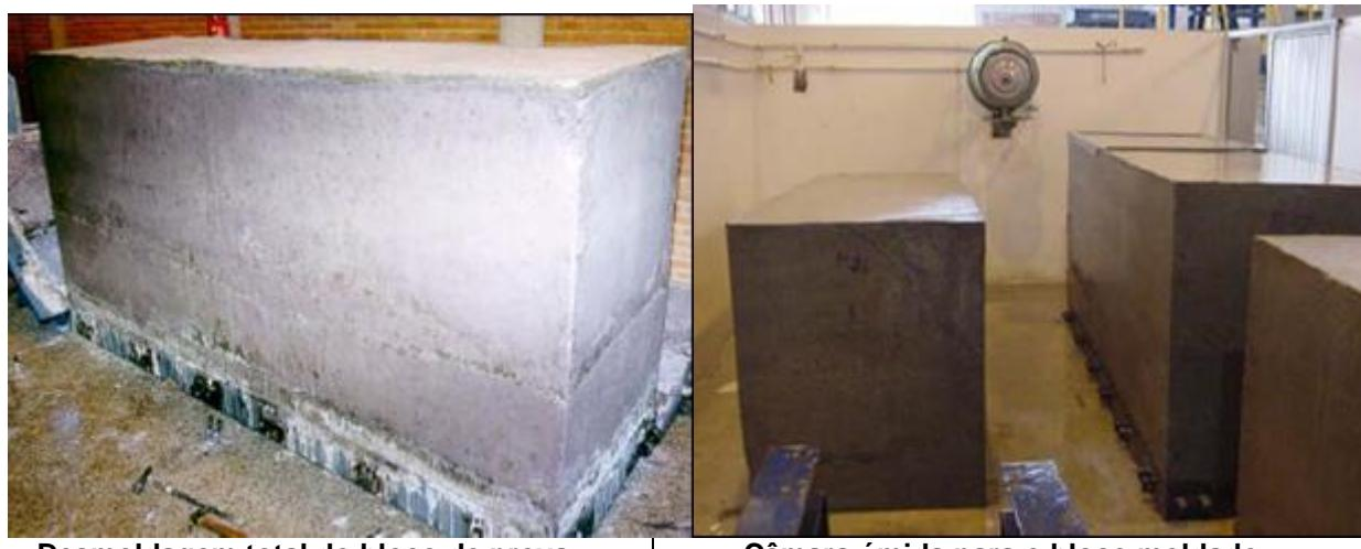
Desmoldagem total do bloco de prova
