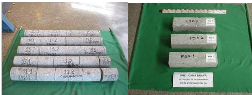
Corpos de prova obtidos dos blocos ensaios de CCR
