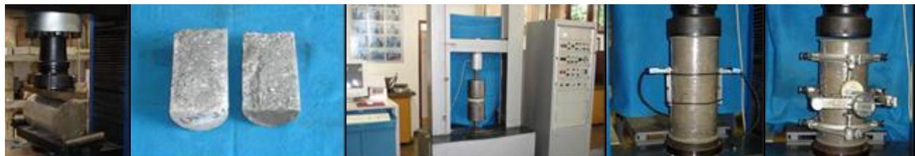
Ensaio de Tração pela Compressão Diametral
