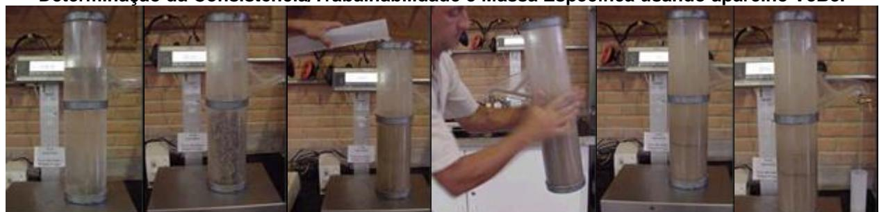
Determinação da Massa específica e Teor de Água pelo DMA (“Dispositivo Medidor de Água”- desenvolvido por Pacelli ao redor de 2003.
