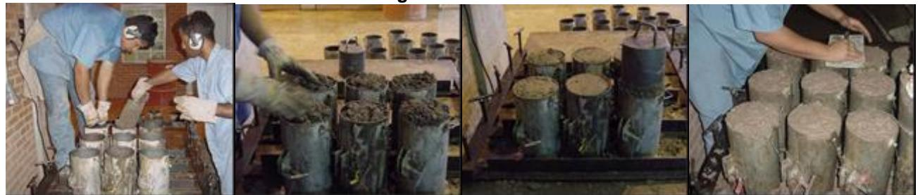
Moldagem dos corpos de prova cilíndricos com CCR
