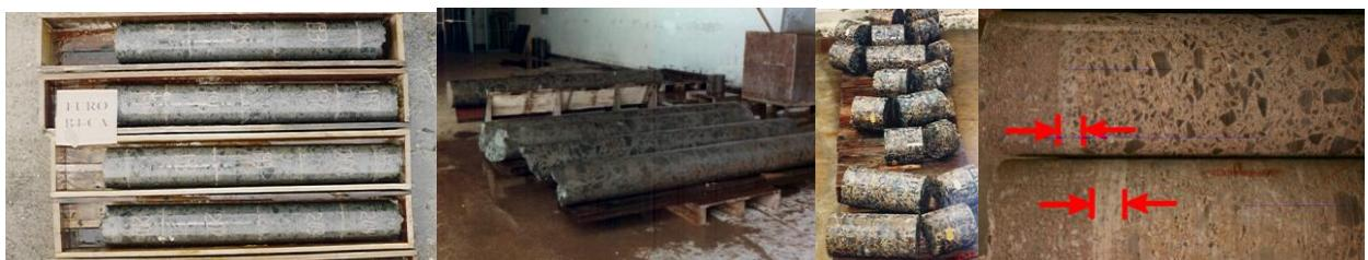
Testemunhos extraídos para ensaios e inspeção do comportamento das juntas de construção e do uso da argamassa de berço.
