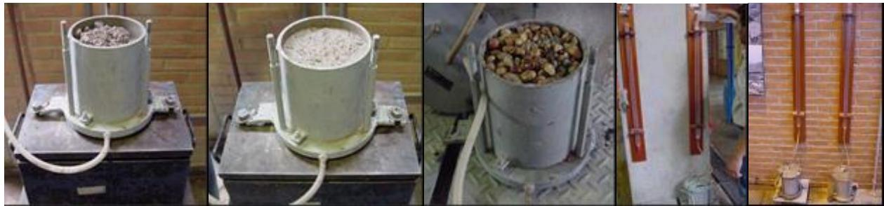
Ensaio de Permeabilidade do CCR fresco para avaliar a dosagem e os vazios da composição granulométrica
